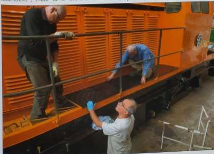
Ci-dessous CMCF - On s'affaire aux derniers détails, comme la repose des platelages.
