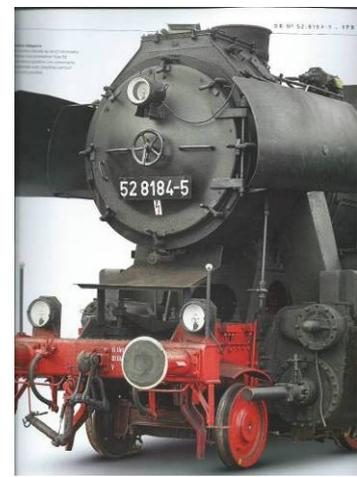
Une fois ces retouches terminées, la machine recevra ses dernières pièces de super-détaillage (l'éclairage sous châssis ainsi que les rambardes horizontales, mains courantes, que j'ai décidé de monter en dernier lieu, car extrêmement fines et fragiles), ainsi que ses marquages par décalcomanies.
