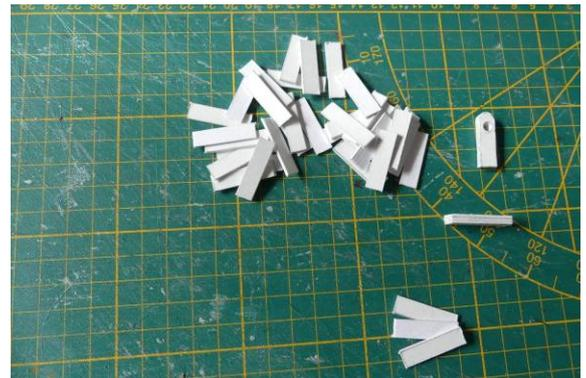
Trois épaisseurs contrecollées sont nécessaires pour composer le poteau proprement dit ; le haut de ce dernier est mis en forme au gabarit, puis il est percé pour accueillir la barrière horizontale qui n'est autre qu'un pic à brochette.
