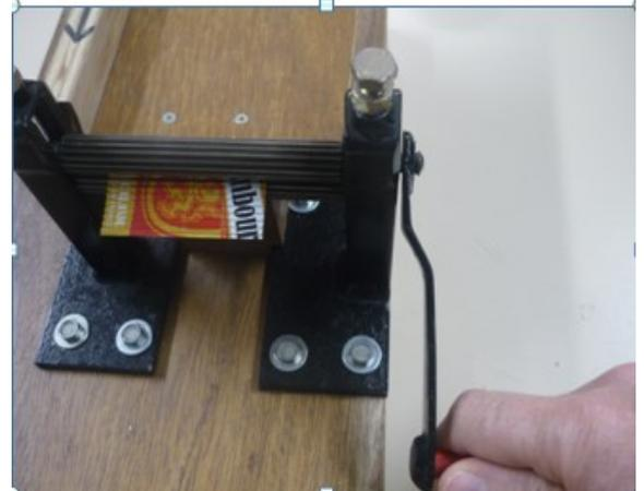
*Ci-contre, la machine de conception maison, équipée de rouleaux crantés provenant d'une machine à écrire, permet de fabriquer les tôles ondulées*
